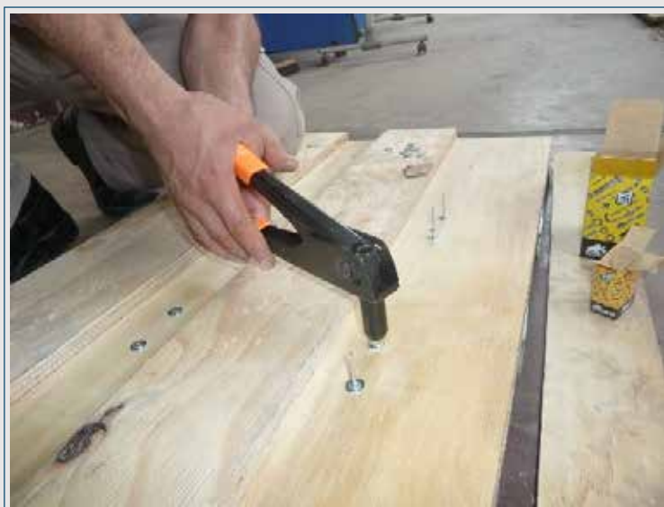
Colocación de remaches
