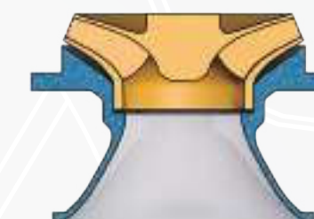
PRIMERA ETAPA DE BAJO NPSH CON SUCCIÓN SIMPLE
