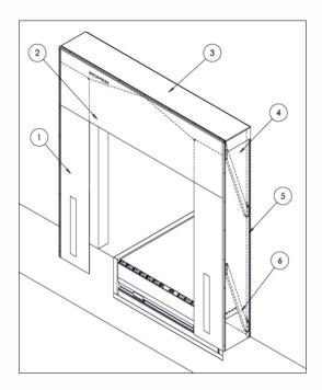
El diseño retráctil del bastidor absorbe los movimientos verticales producidos en el vehículo durante la operación de carga y descarga, así como posibles golpes producidos por el mismo durante su aproximación al muelle de carga. Las lonas frontales de alta resistencia y flexibilidad mantienen su posición gracias al tensor elástico sujeto al bastidor.
